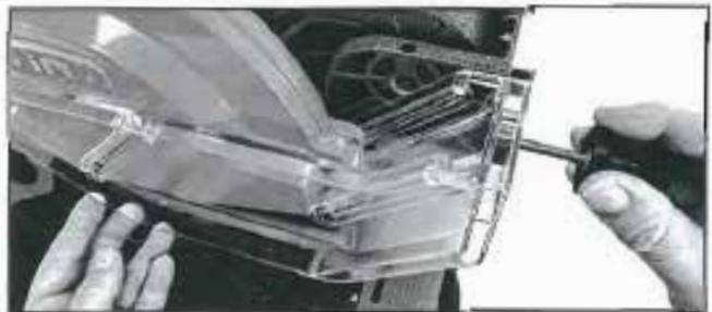
Installierter Halterungsbock für den Staubschutz.
