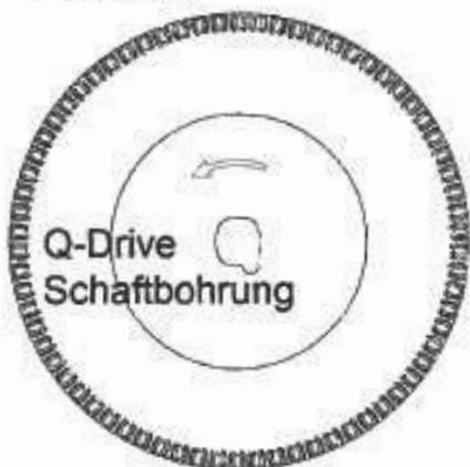
Die Q-Drive Schaftbohrung mit der enthaltenen Buchse ist auch für eine standardmäßige 5/8 Zoll Kreissägeblattwelle passend und bietet damit Flexibilität.
