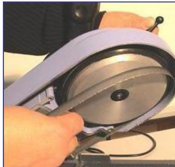
Zum Transport Anschlag und Klemmkeil entfernen, Schneidkopf geradestellen und nach unten drücken.
