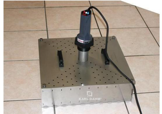
Wenn sich eine Schadensstelle unter dem Fliesenbelag befindet oder ein Kernloch gebohrt werden muss, war es bisher die Regel, die betroffene Fliese zu zerstören und nach Ausführung der Sanierungsarbeiten zu ersetzen. Das Problem: seltene Fliesen oder ältere Dekore, die nicht mehr – oder nur mit hohem finanziellem Aufwand – zu beschaffen sind. Sie können die meisten Fliesen zerstörungsfrei aufnehmen und nach ausgeführter Sanierung wieder einsetzen.
