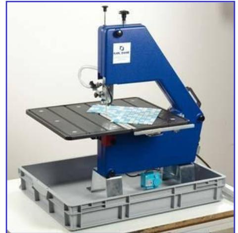
Präzise Justierung des Sägeblattes und wartungsfreie Kugellager garantieren einen leisen Lauf sowie eine gute Lebensdauer des Blattes. Über einstellbare Führungselemente wird das Sägeblatt in der Arbeitsposition gehalten und gewährleistet somit einen präzisen Schnitt. Diese Diamant -Bandsäge grundsätzlich nur im Nassschnitt verwenden. Dabei wird die Wasserwanne soweit gefüllt bis die Wasserpumpe ganz im Wasser liegt. Durch das Einschalten der Bandsäge wird die Wasserpumpe in Betrieb gesetzt.
