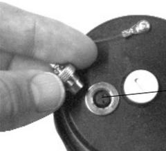
*Buchse auf der Rückseite des Manometers*
