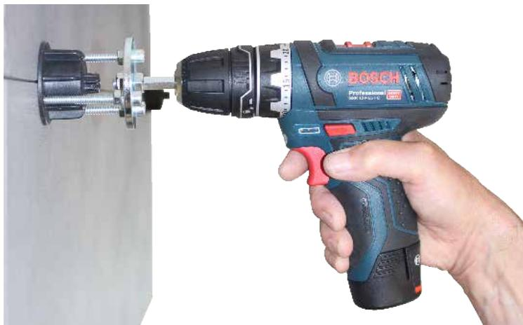
Levelmac® Drehstab 60 mm zum Entfernen der Zughauben an der Wand.
