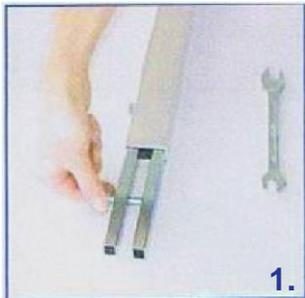
Entfernen der Schraube zwischen beiden Vierkantrohren.
