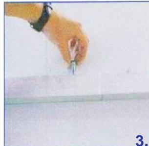
Fixieren Sie diese durch Eindrehen der Schraube und ziehen Sie sie mit einem Maulschlüssel (Gr. 13) fest.
