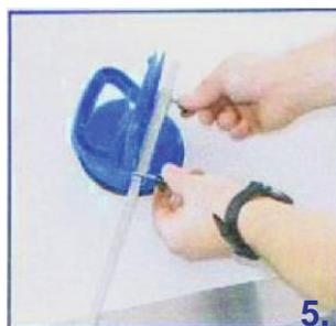
Saugheber über den Alu-Vierkantstab schieben und mit beiden Rändelschrauben fixieren. **Saugheber vor Gebrauch reinigen und anfeuchten.**
