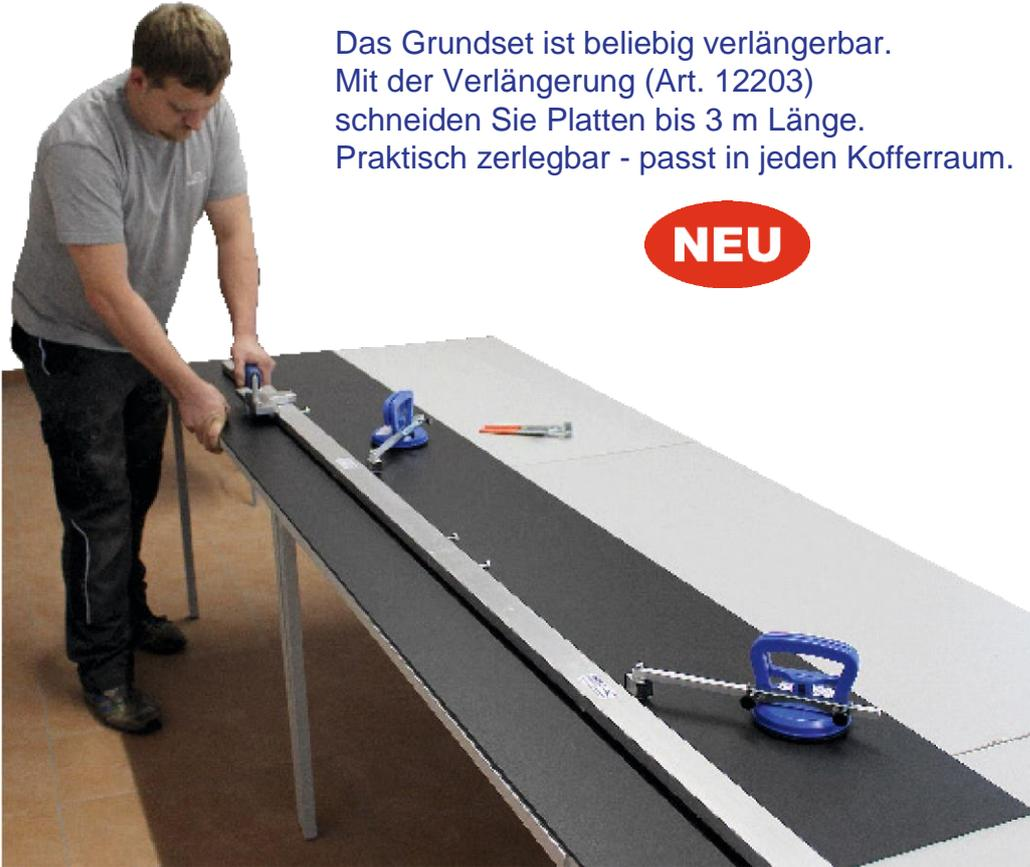
Schneideschlitten auf Führungsschiene aufsetzen und mit Druck an Fliese und Führungsschiene entlangfahren.
