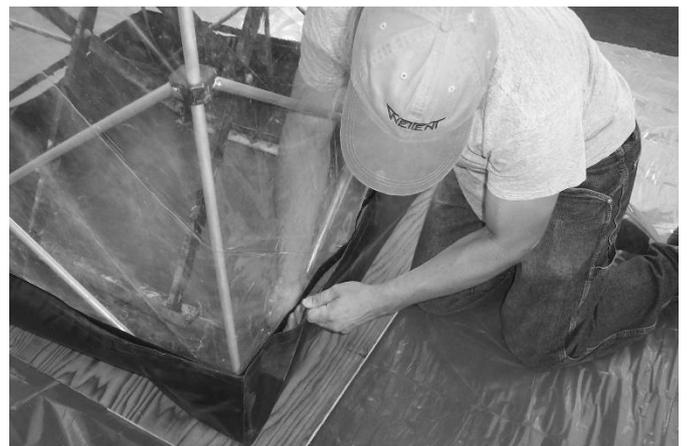
12) Klettverschluss zwischen Nassschneikabine und Bodenwanne befestigen. Achten Sie darauf, dass die Bodenwanne außen abschließt.
