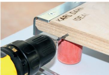
Bohrlöcher mit 3,5 mm Holzbohrer vorbohren.
