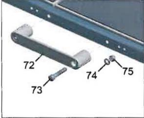
Fixieren Sie den Führungskopf mit der Transportsicherung (Pos. 17a) fest an der Führungsschiene (Pos. 29). Befestigen Sie den Tragegriff (Pos. 72) mit den beigelegten Schrauben (Pos. 73), Beilagscheiben (Pos. 74) und Muttern (Pos. 75) mit einem Inbusschlüssel (SW 6) und einem Gabelschlüssel (SW 13).
