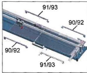
Fixieren Sie die Seitenauflageverbreiterung (Pos. 90 + 91 bei Schnittlänge 630 1 720 1 920 mm bzw. Pos. 92 + 93 bei Schnittlänge 1250 1 1550 1 1830 mm) mit den beigelegten Schrauben (Pos. 95), Beilagscheiben (Pos. 94a) und Muttern (Pos. 94) mit einem Gabelschlüssel (SW 10).
