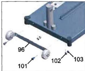
Befestigen Sie die Transporträderhalterung (Pos. 96) mit den beigelegten Schrauben (Pos. 101), Beilagscheiben (Pos. 102) und Muttern (Pos. 103) mit einem Gabelschlüssel (SW 10).
