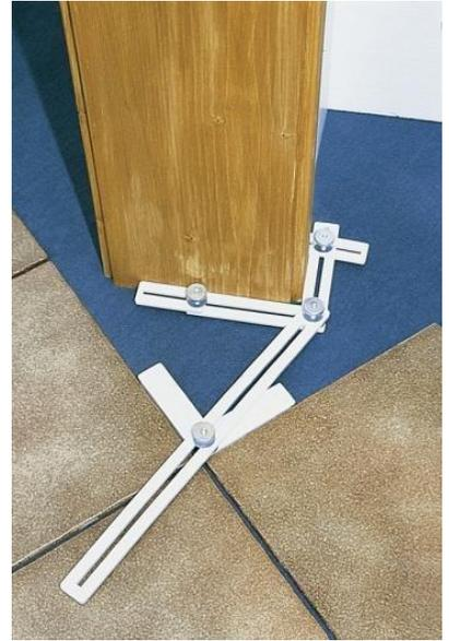
**Sie müssen den Diagonalfix nur einmal anlegen, mit Rändelschrauben feststellen, dann auf die ausgelegten Fliesen auflegen, zuschneiden, fertig!**
